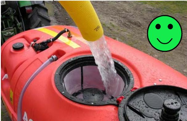
Fig. 61 – Corretto riempimento del serbatoio dell'irroratrice (foto ISK) .
