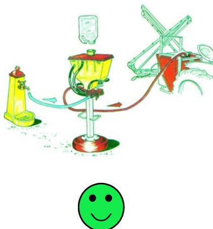
Fig. 67 – I premiscelatori possono essere montati direttamente sull'irroratrice (sinistra) oppure indipendenti (destra) ed alimentati direttamente dalla rete idrica dell'acquedotto.
