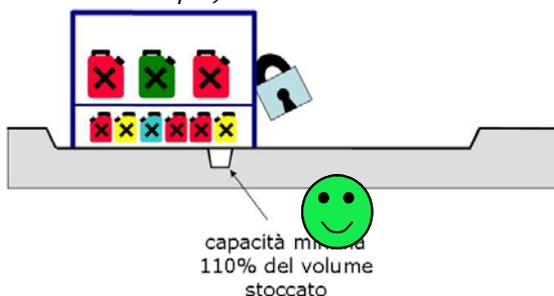
Fig. 20 - Capacità minima del serbatoio per la raccolta delle acque contaminate.
