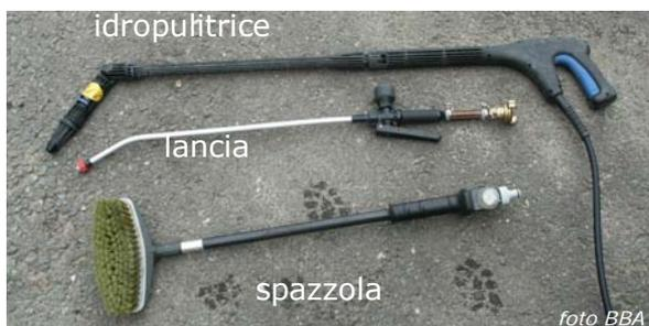
Fig. 89 – Differenti attrezzature per il lavaggio esterno dell'irroratrice.
